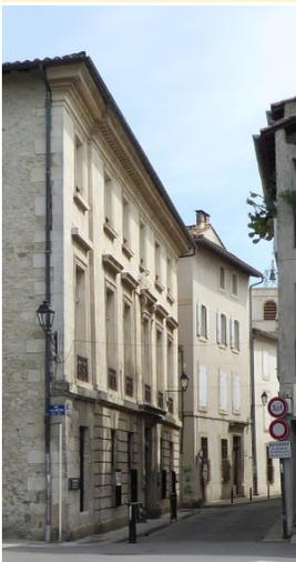
Toutes les modénatures ne sont pas forcément réalisées dans le même matériau, pierre de taille ou mortier ou plâtre sont choisis en fonction des moyens disponibles, du temps de mise en œuvre, etc.
